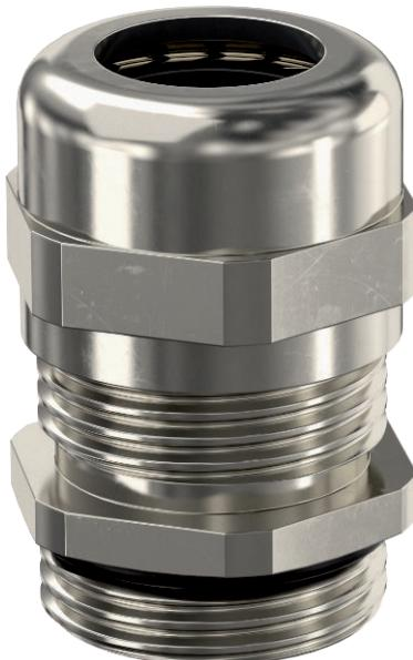
Bucim resistente com rosca métrica conforme IEC 423 para grandes selagens. Alívio de tensão, proteção contra torção e impermeabilidade em toda a área de aperto. Anel de vedação em neopreno. Elemento de aperto em poliamida. Com anel de vedação pré-montado na rosca, testado pela VDE conforme EN 50262, grau de proteção IP68 com 5 bar/1 h, Temperatura de utilização - 20 - 100°C.
