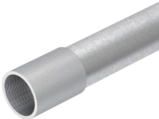
Tubo de instalação elétrica conforme EN 61386-1, com pontas roscadas conforme DIN EN 60423, para a proteção mecânica de cabos e condutores. Com parede interior sem rebarbas. Classe de proteção contra corrosão 4 (elevada). Cada tubo já inclui uma união instalada.
