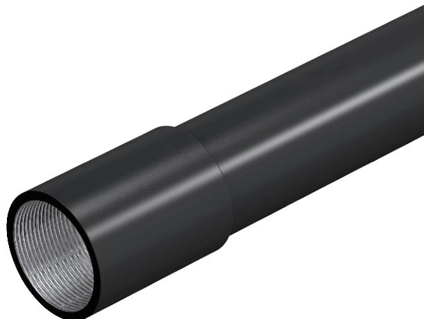
Tubo de instalação elétrica conforme EN 61386-1, com pontas roscadas conforme DIN EN 60423, para a proteção mecânica de cabos e condutores. Com parede interior sem rebarbas. Classe de proteção contra corrosão 2 (média). Cada tubo já inclui uma união instalada.
