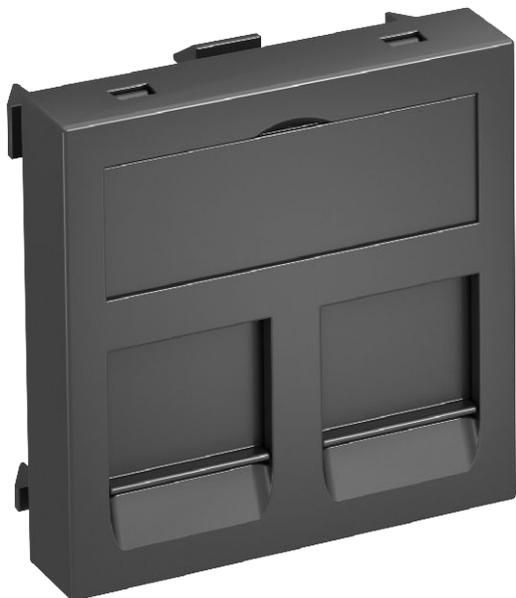
Espelho para conectores de dados com saída plana e fecho de corredeira para alojamento de dois conectores RJ45. A saída tem uma tampa deslizante de bloqueio, adequada tanto para a instalação vertical como horizontal. O Tipo A tem uma abertura de montagem de 20,10 x 14,80 mm e foi concebido para a fixação direta de conectores de dados.
