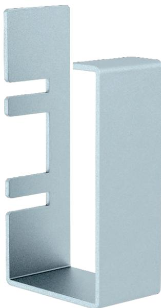
Grampo para calhas do tipo LKM 60100FS, evita a queda do cabo e dos tubos durante a instalação. O grampo é obrigatório quando a calha é usada em sistemas de cabos com manutenção de funções integrada, de acordo com DIN 4102 parte 12. Montagem simples graças à inserção na perfuração na base da calha.
