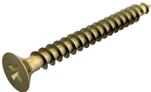
Aço temperado, galvanizado a zinco e passivado a amarelo, bem como revestido a Hostaflon. Cabeça de embeber com parafuso Philips (Pozidrive tamanho 2, exceto Ø 6 mm Pozidrive tamanho 3).
