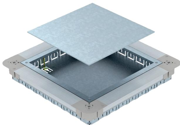
Caixa de pavimento com aro de redução e tampa cega com paredes laterais de chapa de aço. Para a instalação de tampa de encastramento quadrada GES9 55 em alturas de pavimento a partir de 55 mm. Pode ser continuamente nivelada até à altura da betonilha e a betonilha pode ser nivelada com a aresta de descarga da betonilha. Com aberturas para tubos de condução de cada lado 7 x M20, 3 x M25, 4 x M32. Tamanho útil do tubo com altura de sistema de 55 mm: M20.
