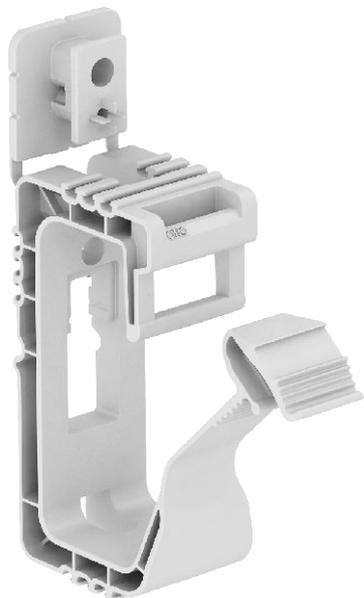
Abraçadeira para aplicação universal, com aberturas de fixação de 6 mm Ø adequada para montagem na parede e no teto. O elemento de fixação pode ser fixo com um tapete ou uma pistola de pregos de pressão. A distância de fixação recomendada entre as abraçadeiras com ocupação total é de 50-60 cm.
