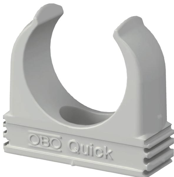
Abraçadeira Quick do tipo 2955F/... da OBO: versão resistente ao teste do fio incandescente para todos os tubos metálicos métricos, bem como para tubos métricos de isolamento para pequenas e grandes cargas. Adequada para a fixação do Quick-Pipe da OBO.
