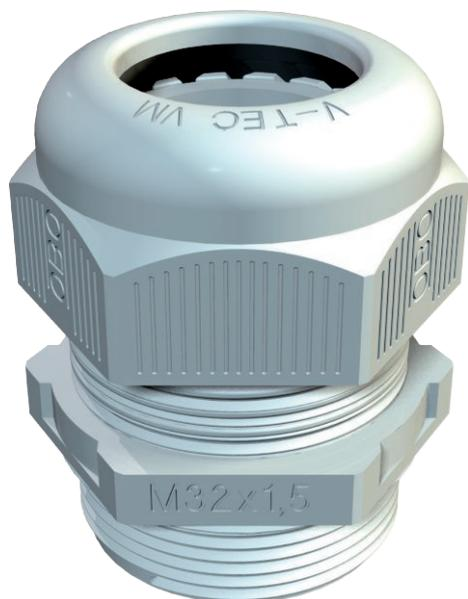
A forma mais rápida e confortável de assegurar o alívio de tensão e a estanquidade em caixas de derivação e armários de distribuição: os bucms certificados V-TEC VM da OBO. Com a borracha de proteção integrada e as lamelas especiais OBO é conseguido o grau de proteção IP68. O alívio de tensão e estanquidade estão testados de acordo com a DIN EN 62444.
