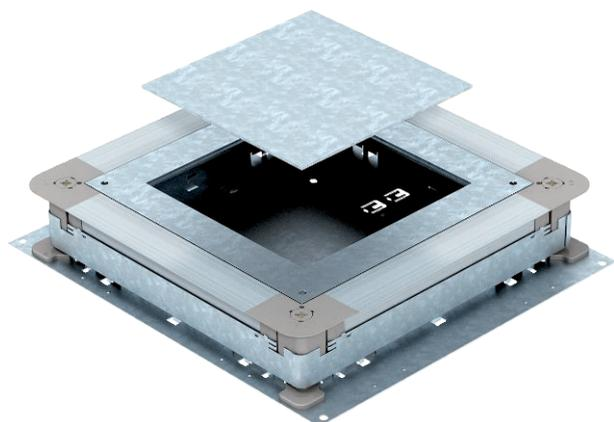
Caixa de pavimento para calhas de chão com paredes laterais de chapa de aço. Para montagem de tampa do tamanho selecionado. Pode ser continuamente nivelada até à altura da betonilha (possível nivelamento rápido) e a betonilha pode ser nivelada com a aresta de descarga da betonilha. Com opção de desacoplamento acústico após a colocação do pavimento e com acessórios do sistema também adequadas para aplicações em grandes cargas.
