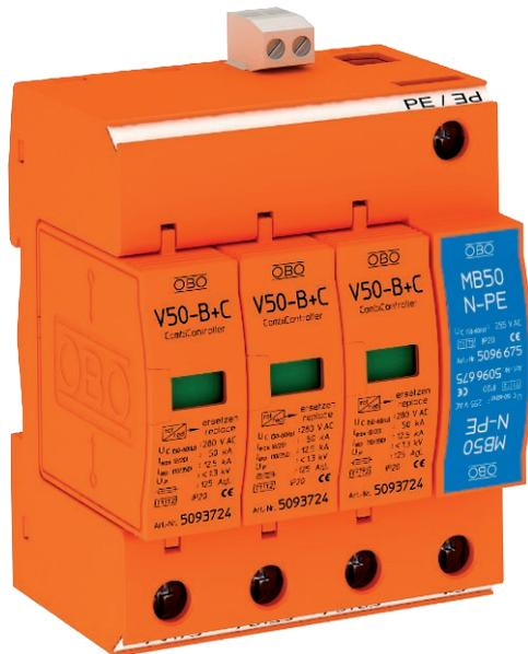
Descarregador combinado, descarregador de descargas atmosféricas e de sobretensões tipo 1+2 conforme DIN EN 61643-11.
