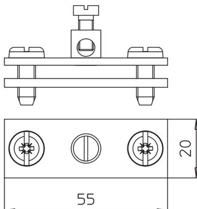
Possibilidade de ligação 1 | Borne de ligação à terra do cabo até 16 mm<sup>2</sup> x máx. FL30.
