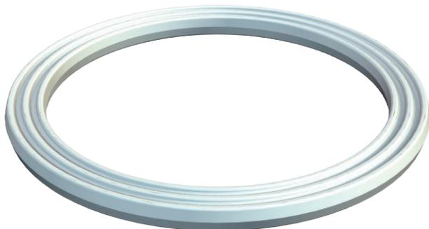
Anel de vedação para rosca, adequado para todos os buçins em plástico com rosca métrica conforme DIN EN 60423 ou ISO 68. O diâmetro interior dos anéis de vedação são concebidos de forma a estes poderem ser pré-montados sem risco de se perderem.
