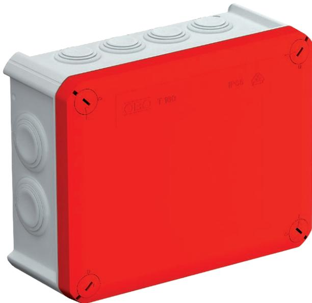
Caixa de derivação para conectar cabos em áreas interiores e áreas exteriores protegidas. Forma retangular com buçins cónicos nas laterais e entradas quebráveis na base. Adequado para a montagem na parede / teto e para a montagem em suportes para caixas de derivação. Com opção de fixação interna e montagem através de parafusos nos cantos. Tampa com fecho rápido, pode ser selada a chumbo. Fabricado em materiais livres de halogéneo.
