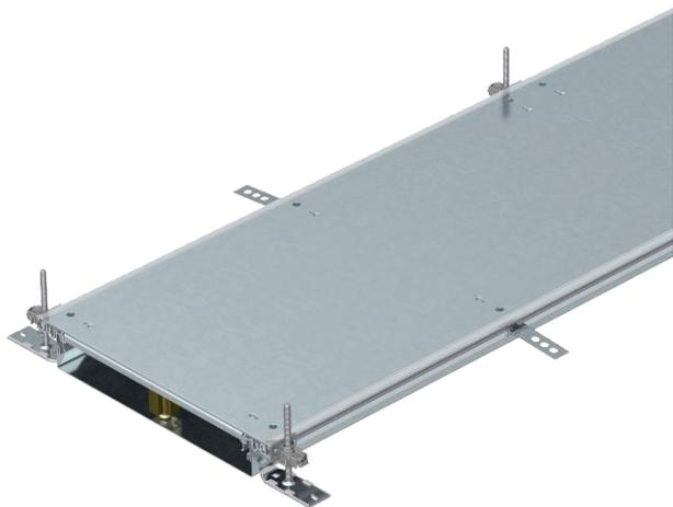
Calha para a condução de cabos, com 3 tampas com mola, constituída por base e laterais em chapa. Base inferior do pavimento com entalhes para a montagem por encaixe dos separadores. O material fornecido inclui 6 esquadros de fixação com nivelamento de altura, 6 escoras estabilizadoras e 6 escoras estabilizadoras e tampas 3 unid. em calhas de 200, 300 e de 400 e 6 unid. em calhas de 500 e 600. Calha fornecida com a tampa de mola montada
