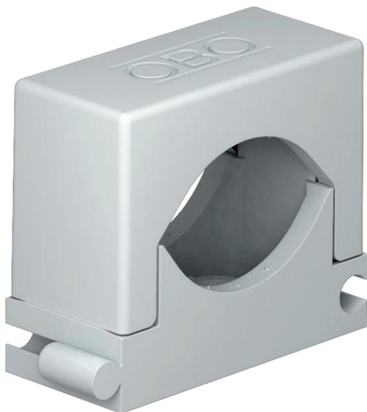
Abraçadeira universal para a fixação individual de cabos e tubos, todos os tamanhos podem ser combinados entre si, base com furo oblongo e rosca M6 para ajuste na fixação.
