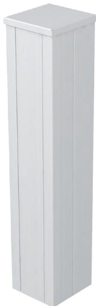
Coluna de distribuição ISS de 2 faces em alumínio com abertura do sistema de 76,5 mm. Vazia, equipada com aparelhos convencionais (tomada, telefone, etc.), máx. 10 aparelhos. Fixação possível diretamente no pavimento. As caixas de aparelhagem terão que ser encomendadas em separado.
