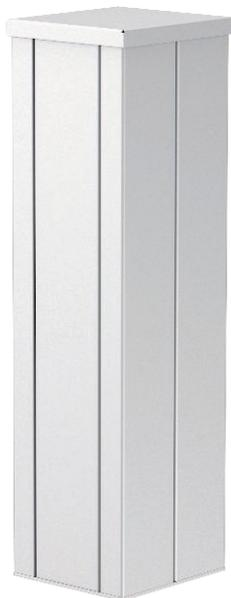
Coluna de distribuição ISS de 2 faces em alumínio com abertura do sistema de 80 mm. Vazia, equipada com aparelhos convencionais (tomada, telefone, etc.), máx. 8 aparelhos. Fixação possível diretamente no pavimento. As caixas de aparelhagem terão que ser encomendadas em separado.
