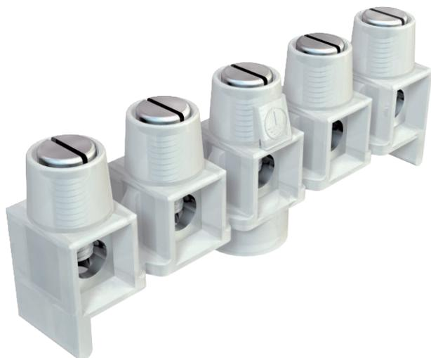
Régua de bornes em latão niquelado, parafusos em aço galvanizados a zinco e passivados de forma transparente, secção transversal nominal 0,8 ÷ 2,5 mm<sup>2</sup>, tensão nominal 660 V, de 5 polos, com conjunto de bornes, máx. secções transversais conectáveis por ponto de borne: 4 x 2,5 mm<sup>2</sup>, 5 x 1,5 mm<sup>2</sup> ou 6 x 1 mm<sup>2</sup>, os polos desnecessários podem ser retirados e utilizados como bornes individuais.
