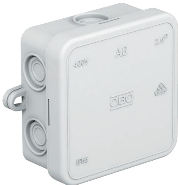
Tipo de proteção IP55, tensão nominal 400 V, secção transversal nominal 2,5 ÷ mm<sup>2</sup>, 7 entradas para cabos com diâmetro de 5-14 mm.
