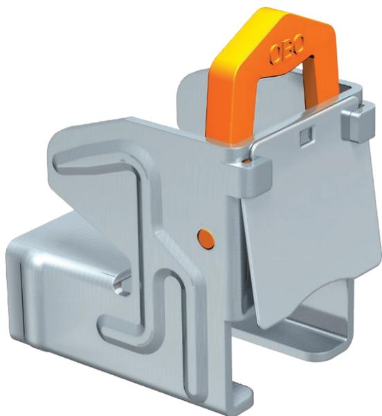
Clip de suspensão sem superfície rosçada e com revestimento anticorrosivo, com mola de bloqueio e adequado para perfis do tipo CML3518 e CMS3518. Para a fixação rápida do caminho de cabos em vigas de aço, abraçadeiras BBS, suspensões para luminárias ou outros, um sistema completo é composto por 2 clips de suspensão e uma peça de perfil C de qualquer comprimento, bem como 2 proteções de topo.
