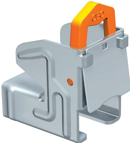
Clip de suspensão sem superfície roscada e com revestimento anticorrosivo, com mola de bloqueio e adequado para perfis do tipo CML3518 e CMS3518. Para a fixação rápida do caminho de cabos em vigas de aço, abraçadeiras BBS, suspensões para luminárias ou outros, um sistema completo é composto por 2 clips de suspensão e uma peça de perfil C de qualquer comprimento, bem como 2 proteções de topo.
