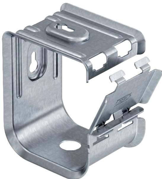
Abraçadeira em metal para uma elevada resistência mecânica, mesmo em caso de incêndio. Adequada para uma montagem segura, sobre tetos corta-fogo. Aprovada também como variante de suporte específico de cabos para manutenção de funções segundo DIN 4102 parte 12. Para montagem na parede e no teto. A abraçadeira pode ser aberta sem usar ferramentas. Informações detalhadas sobre as opções de instalação aprovadas podem ser encontradas nos documentos de teste correspondentes.
