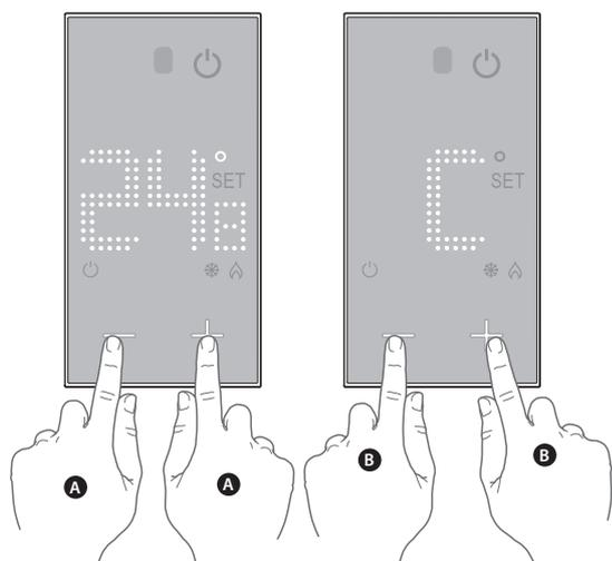
Appuyer simultanément sur les touches + et - (A) pendant plus de 5 secondes : le format actuel de température s'affiche (C = degrés Celsius ou F = degrés Fahrenheit) ; appuyer sur la touche + ou - (B) pour le modifier.
