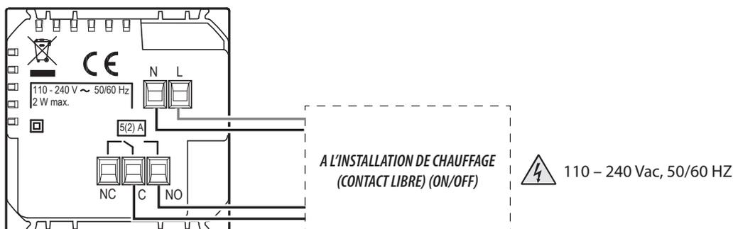
Installation pour chauffage uniquement avec charge à commander à la tension de secteur (ex. électrovanne 230 V)
