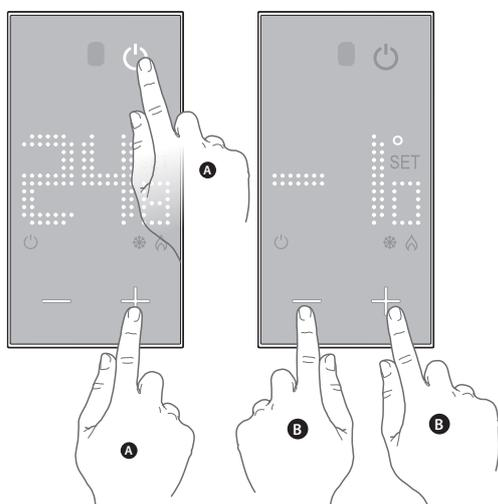
Appuyer simultanément sur les touches ON/OFF (A) et + (B) pendant plus de 5 secondes : l'écart entre la température mesurée et celle affichée par le thermostat s'affiche ; appuyer sur la touche + ou - (C) pour le modifier.
