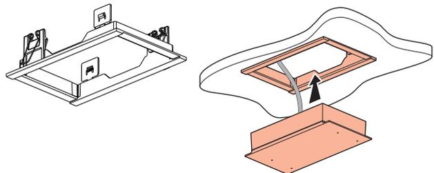
Adaptateur pour remplacement blocs U21, 6 601 92
