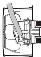
La connexion arrière limite la déformation du câble coaxial, évitant une rupture d'impédance et préserve donc les performances.
