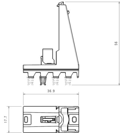
. Module de connexion 1P+N ( réf. 405235), identification des phases et N avec tampongraphie ( N à droit ) :
