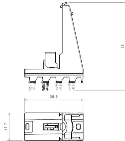
. Module de connexion 1P+N ( réf. 4 052 51 ), identification des phases et N avec tampongraphie ( N à gauche ) :
