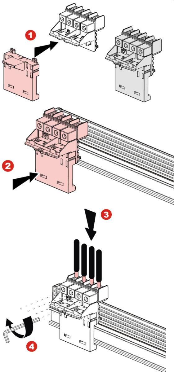
Capacité des bornes du module d'alimentation :
