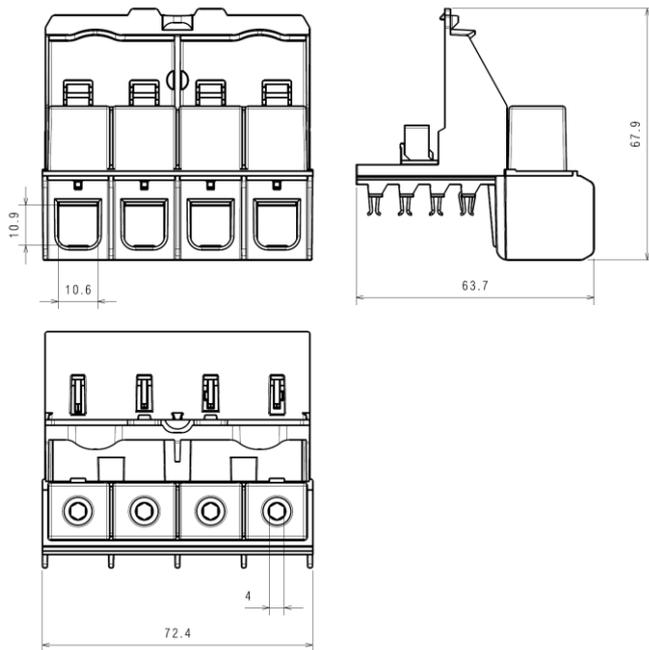
.Module de protection des phases (livré avec le module d'alimentation) :
