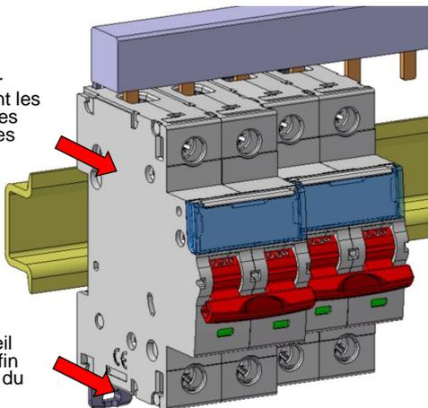
Tirer l'appareil vers l'avant afin de le dégager du rail
