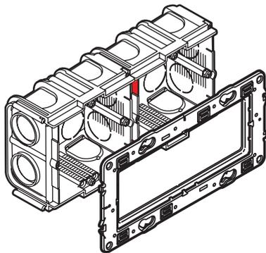
Vissage possible par visseuse, réglage du couple au minimum conseillé.
