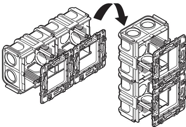
En montage avec des supports multipostes, nécessité de casser les deux parties en rouge dans le cas d'épaisseur de plâtre faible (< 5 mm).
