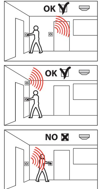
Angles de détection horizontale (pente de 0°) Hoeken horizontale detectie (helling 0°)
