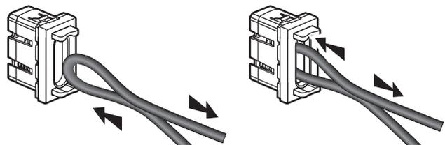
Insérer le câble en faisant une boucle
