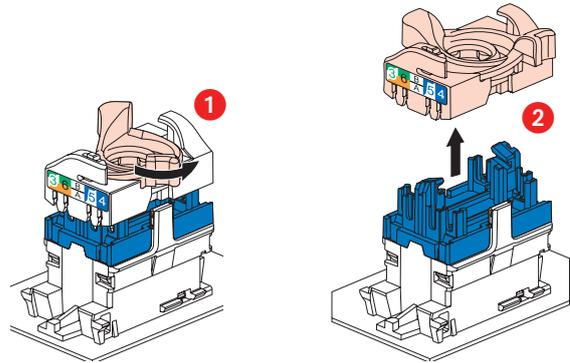
Ce système permet d'épanouir facilement les paires avant montage sur le connecteur.
