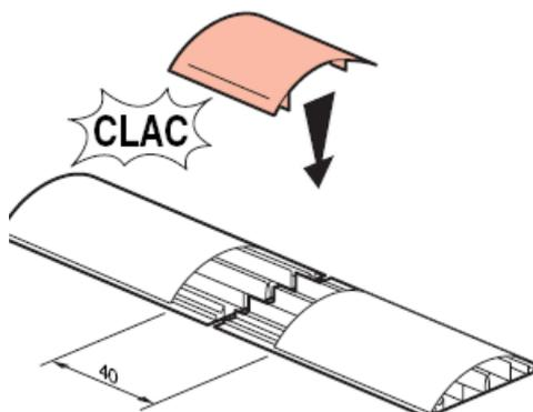
Montage avec passage de plancher 92x20mm
