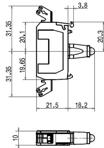
Blocs led raccordement par picots
