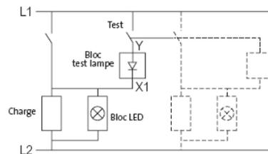
Pour alimentations 24V et 48V AC/DC – test à 2 diodes
