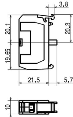
Blocs à contact raccordement par borne à ressort
