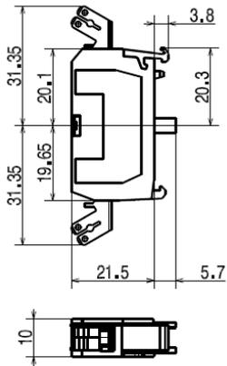
Blocs à contact raccordement par picots
