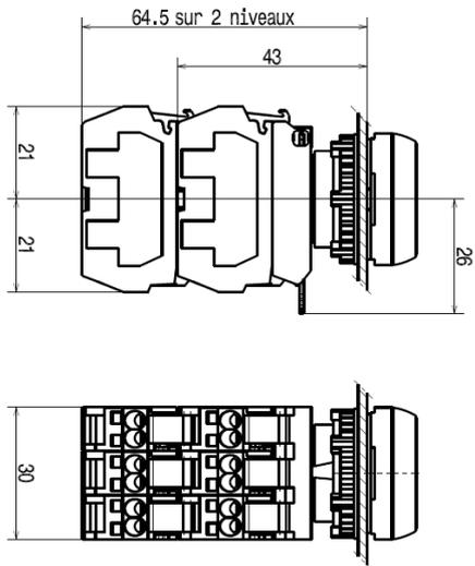
Blocs à raccordement par borne à ressort étrier 5 postes
