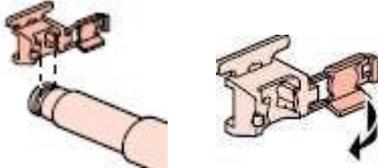
Pour un centrage parfait de la pointe, faire glisser l'adaptateur vers la pastille jusqu'au blocage. Il suffit d'enclencher et de tirer
