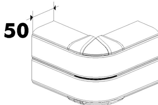
Permet la jonction en angle extérieur de deux morceaux de goulottes de même section :
