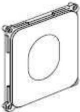
(1 plaque A diamètre 54mm/1 plaque B diamètre 63mm et 1 plaque C diamètre 78mm)
