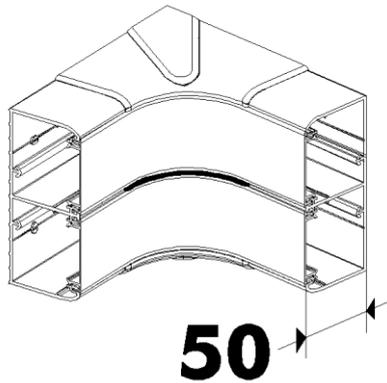
Permet la jonction en angle intérieur de deux morceaux de goulottes de même section :
