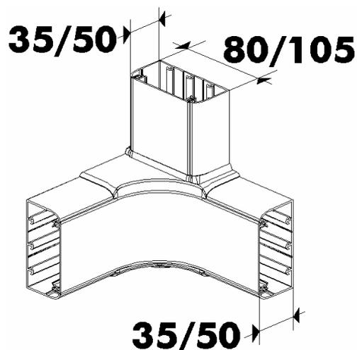
Permet la dérivation dans un angle intérieur sur mur droite ou gauche vers les goulottes 35x80, 35x105, 50x80 ou 50x105 mm. Respect de l'indice de protection. Améliore l'esthétique (recouvrement de la coupe) Montage sur le corps de la goutte par clipsage Coloris blanc
