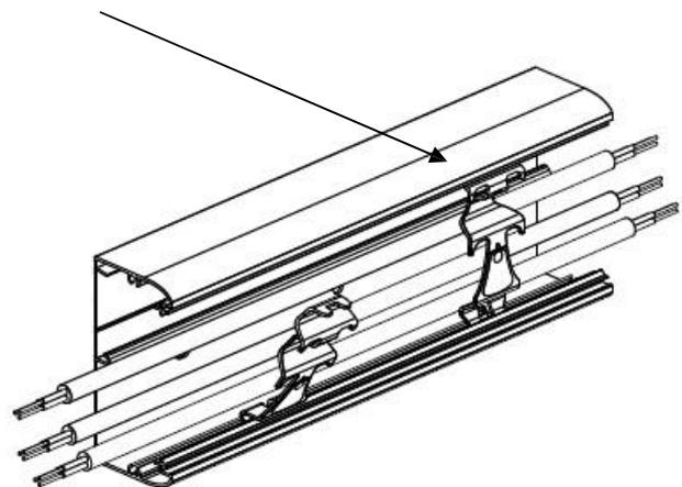
L'agrafe se clip sur la goulotte permettant la retenue des câbles en cours d'installation
