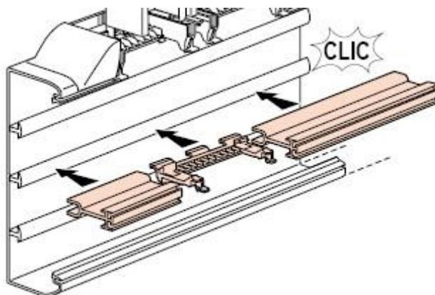
Se fixe directement dans le fond de la goulotte (sur le « Té ») entre deux morceaux de cloison de fractionnement
