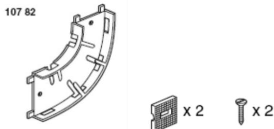
Livré avec 2 supports pour fixation dans le fond de la goulotte (sur le « Té » et 2 vis
