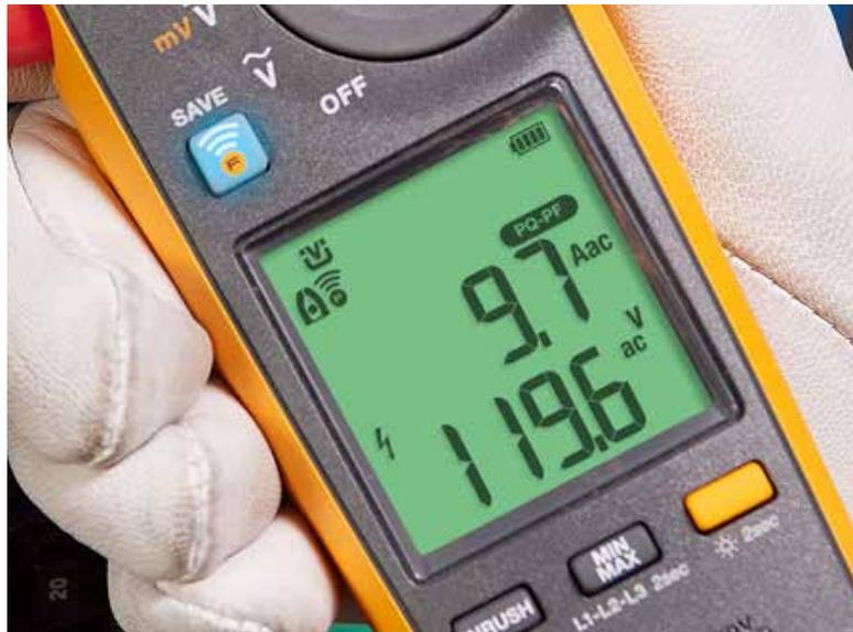
A 378 FC inclui um teste de qualidade de energia que fornece uma indicação rápida se existir um problema de alimentação à entrada ou de equipamento.
