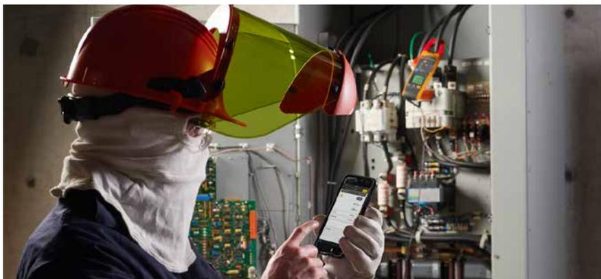
O Fluke Connect permite o envio de medições para um smartphone para registo, colaboração e análise.
