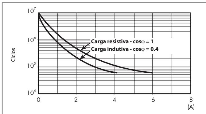
H 39 - Máxima capacidade de ruptura em DC1
