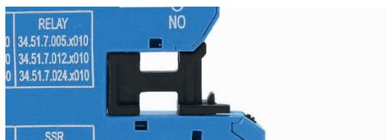
1. Para usar um módulo a fusível, basta remover o módulo de “conexão” e substituí-lo pelo módulo a fusível. O fusível é posicionado eletricamente em série com o terminal de saída comum do interface (11 para versões EMR, 13+ para versões SSR, 15 para temporizador EMR, 15+ para temporizador SSR).
