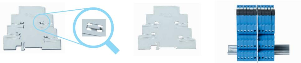
2. Não rompendo as saliências, este separador oferecerá 6.2 mm de espessura. Com a ajuda de uma tesoura, pode-se cortar no local indicado, permitindo a interligação, através do separador, com a utilização do pente de ligação, de 2 grupos diferentes de relés de interface.
