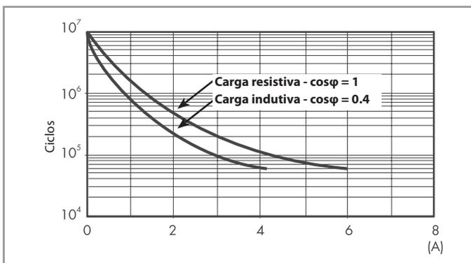
H 34 - Máxima capacidade de ruptura em DC1
