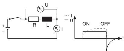
**Comutação das bobinas de relé.**
